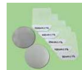
キャリブレーションセット付属 ゼロ校正プレート（2種、Fe・NFe） 標準値プレート（5枚、50 μm ~ 1020 μm ± 1%）
